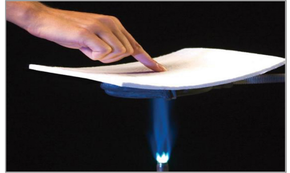
شكل (٢) المقدرة الخارقة لهلاميات الهواء في منع انتقال حرارة شعلة ملتهبة {٢٣}.
