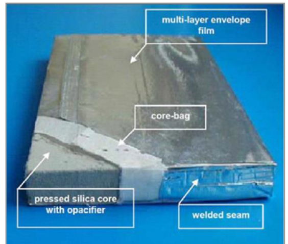
شكل (٦) مخطط توضيحي لمكونات مادة VIP {٤}
