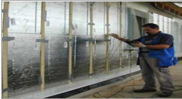
شكل (١٠) اختبار ومراقبة ضغط الغاز بالواح العزل المفرغة من خلال جهاز "va-Q-check" {٣٣}
