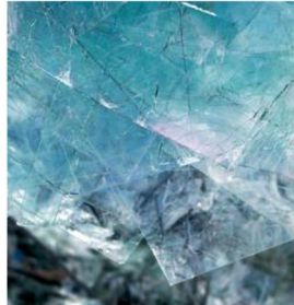
شكل (٤) مادة Foamglas T4+ مصنوعة من زجاج معاد تدوير بنسبة ٦٠%
